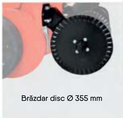
Separator îndepărtare resturi vegetale doar cu brăzdar cu disc cu Ø 355 mm
