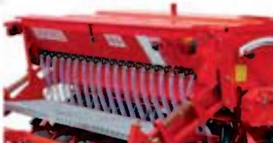
Separator îndepărtare resturi vegetale doar cu brăzdar cu disc cu Ø 355 mm
